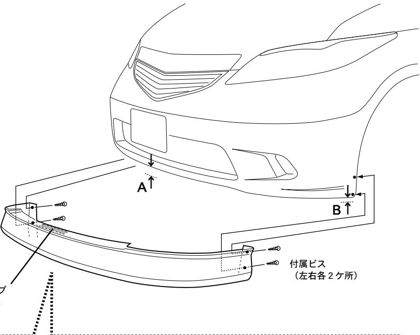
本製品は、精密な設計により数カ所のポイントで確実に車両にはまり込む形状になっておりますので、本書の通り正しく装着頂ければ、フェンダー部のビス4本のみで、下方向は勿論、上方向にもズレたり脱落したりする様な事は有りません。心配で気になさる方の為に、念の為ダクト棚中央部裏側に貼る為の両面テープが付属しておりますが、両面テープをご使用頂いた場合、その厚みでかえってフィッティングに悪影響が出る事も考えられますので、極力ご使用にならない事をお勧め致します。
